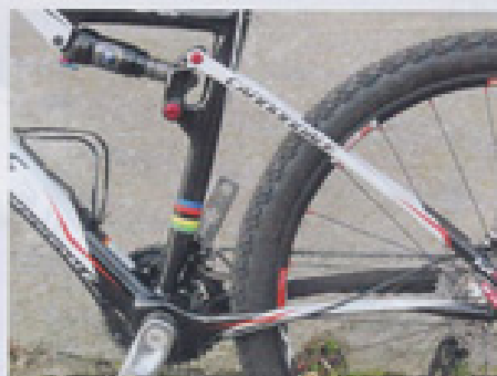
Baghjulets affjedring uden omdrejningspunkter. Læg mærke til kærdestagernes udformning, de er designet til at kunne give baghjulet 80 mm vandring. Bemærk også det kraftige skelår og området omkring krankboksen
