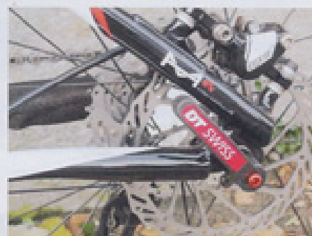
Her er et af de meget få steder, hvor Cannondale er gået på kompromis. Gaffelenderne og postmount-beslagene til bremsekaliberen er af aluminium
