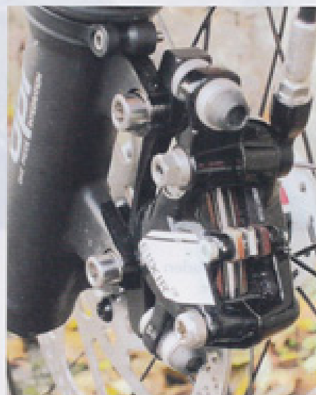
Når forhjulet skal afmonteres, kræver det, på grund af konstruktionen, at bremsekaliberen fjernes først. Cannondale har gjort det lettere ved at lave slider i monteringshullerne på gaffelbenet, det er bare at løsne skrueene en smule, så kan kaliberen fjernes. Til gengæld skal hjulet ikke afmonteres, når man skal fikske en punktering
